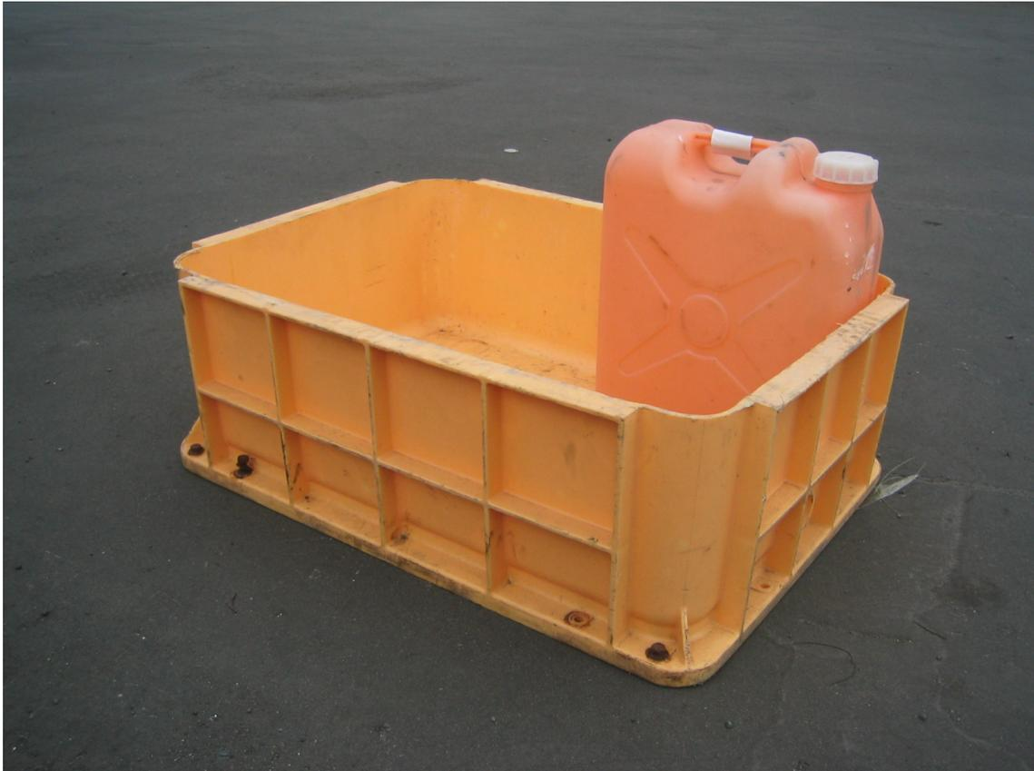
ポリプロピレン製のボックスに廃棄物の入った容器を収納した状態で運搬を行う
